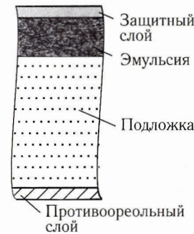
Рис. 5.1. Структура типичной негативной фотопленки (без соблюдения масштаба)
