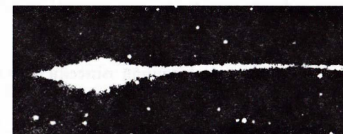
Рис. 8.15. Фон ЭОП от нейтронов, в виде ярких точек.
