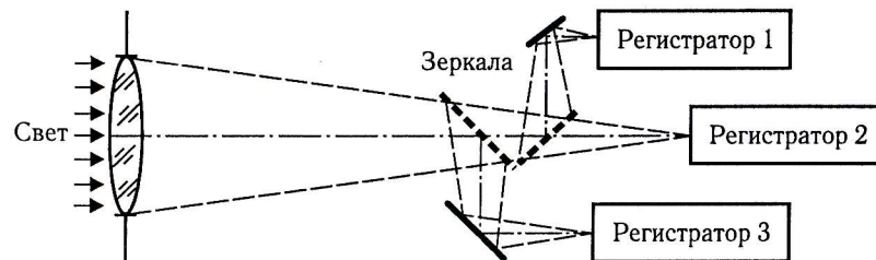
Рис. 1.11. Размножение изображения путем деления светового пучка полупрозрачными (---) и глухими (—) зеркалами
