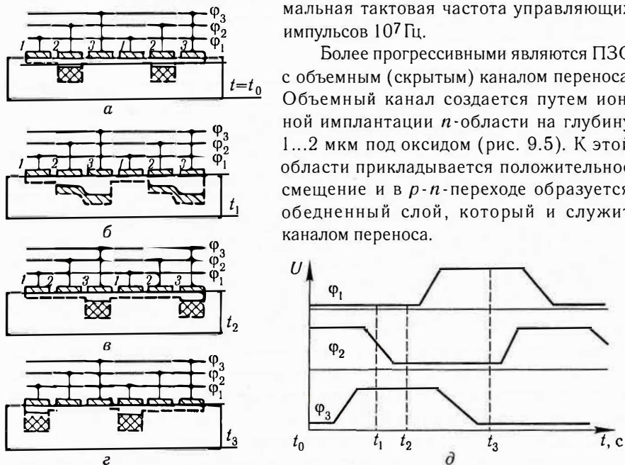
Рис. 9.4. Схема переноса зарядов в трехфазном ПЗС [42]:
