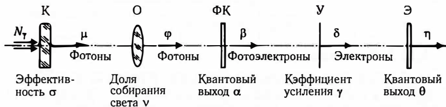
Рис. 8.17. К расчету отношения «сигнал/шум»:
