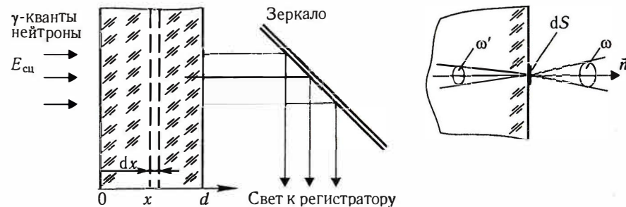
Рис. 7.9. К расчету яркости свечения сцинтилляционного конвертора
